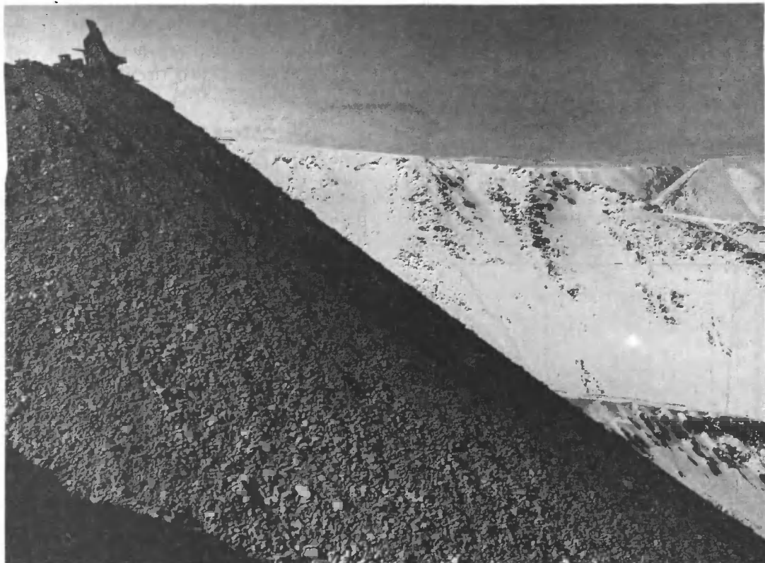
Разгрузка 108-тонного автосамосвала непосредственно на откос отвала через его предохранительный вал.
