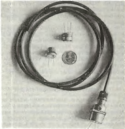
Передающий модуль для стекловолоконной линии связи на основе инжекционного лазера на InGaPAs. Показаны отдельные диоды (в центре) и окончательное устройство в сборке с отрезком волоконно-оптического кабеля.
